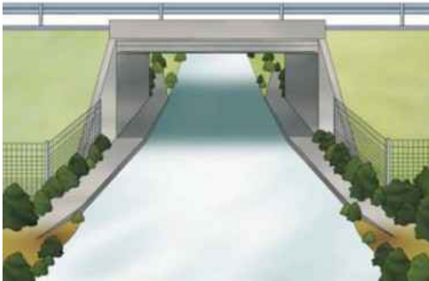
Esquema general de un drenaje transversal adaptado para animales terrestres.
