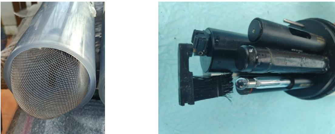
Figura 4 Instalación rejillas inox y sistema de limpieza
