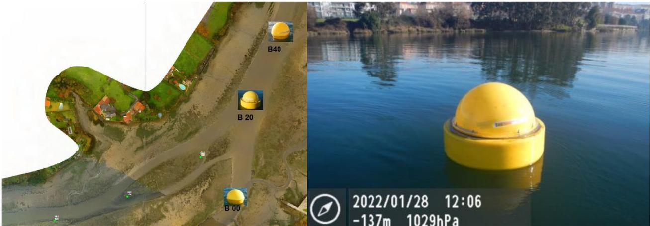
Figura 3 Instalación de boyas de medición de turbidez. Fecha 28 de enero de 2022.
