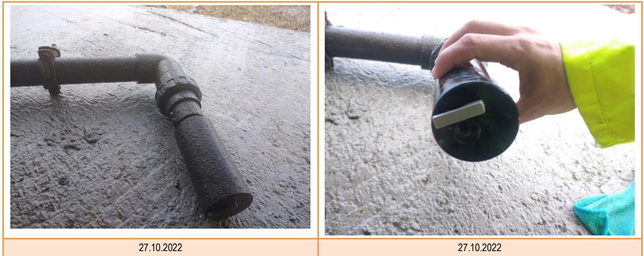
**Figura 11** Limpieza y reposición del sensor de medición de turbidez de la laguna de Fonteculler.
