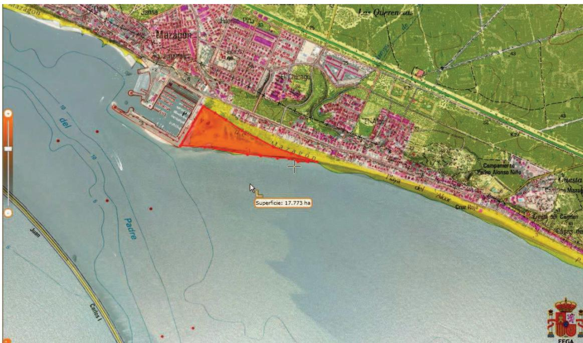
Figura 2.19: Superficie entre la línea de orilla de la ortoimagen y carta náutica en el triángulo acumulativo apoyado en el puerto de Mazagón (fuente: SIGPAC)
