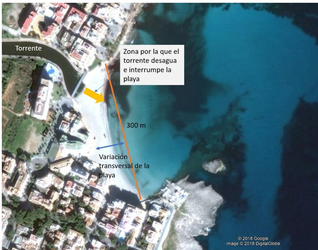
**Figura 5.5. Esquema de funcionamiento de la playa encajada de S'illot**
