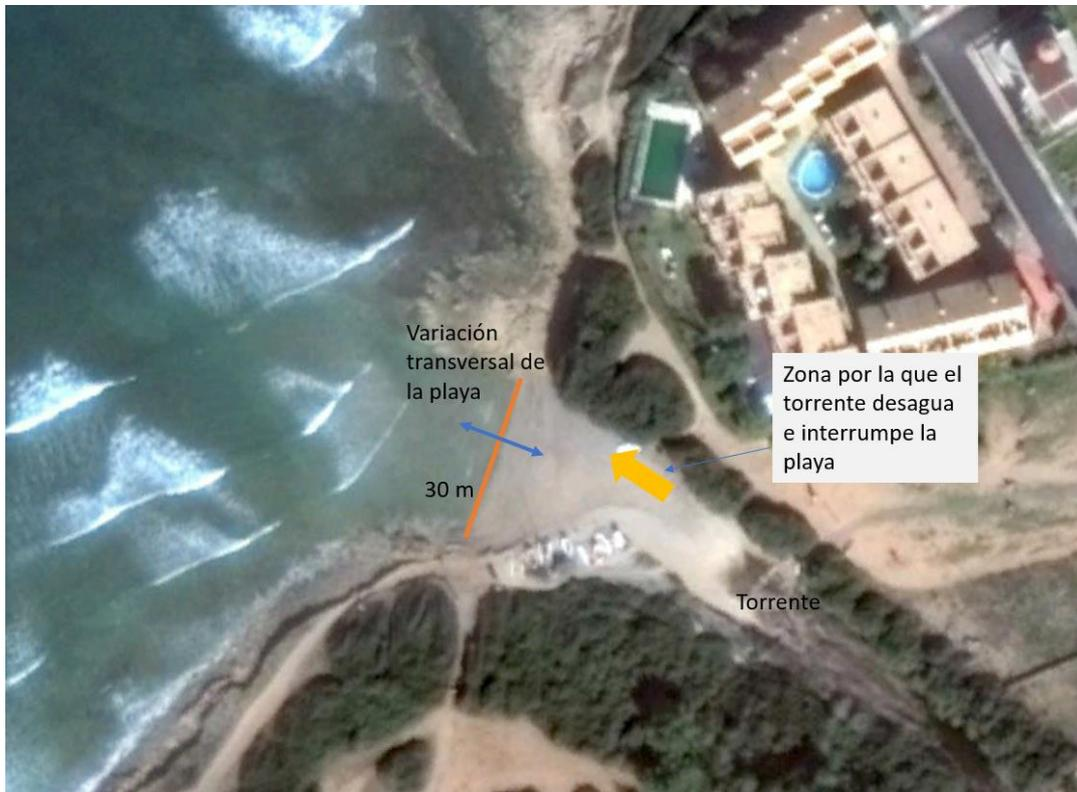
**Figura 5.7. Esquema de funcionamiento de la playa encajada de s'Estanyol**
