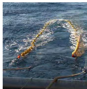
El muestreador es por tanto una red de gran abertura vertical (368 KW –4.5 tons-) modificada para poder trabajar con barcos diferentes a una velocidad de 3.0 nudos. La abertura horizontal y vertical sobre el fondo se ha estimado en 16 y 2.7-3.2 m, respectivamente (Fiorentini et al. (1999), Dremière et al. (1999) y Bertrand et al. (2002b). Todos los muestreos son diurnos, de 30 ó 60 minutos de duración efectiva (desde que la red
