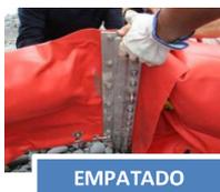
Las barreras se enlazan unas con otras hasta alcanzar la longitud deseada.
