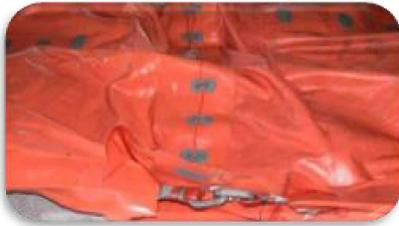
Otro sistema utilizado en muchas barreras de construcción nórdica es el **sistema noruego** de conexión mediante hoyados y ojales, un sistema muy sencillo, que no utiliza piezas metálicas que lo hace muy flexible y por ello se adapta muy bien al oleaje sin crear tensiones en las cabezas. Este sistema se asegura mediante un simple cabo que cose los ojales de ambas cabezas, en su contra el cosido de las cabezas es un trabajo lento y difícil de realizar en barreras a flote.
