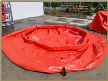
Los **tanques autoportantes** son tanques abiertos en su parte superior, ligeros y portátiles provistos de un anillo flotante. Ocupan poco espacio plegados y su montaje no requiere de elementos auxiliares como estructura o herramientas. Son aptos para el almacenamiento temporal de aguas de vertido e hidrocarburos antes de su gestión final. El tanque aumenta su tamaño a medida que se llena con líquido. El único requisito es que se instale en una superficie plana.
