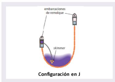
La barrera se puede configurar en forma de una **J** que desviaré el petróleo hacia un "skimmer", permitiendo así la contención y la recuperación simultáneas.
