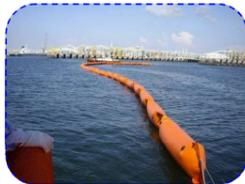
La flotabilidad se consigue por medio de una cámara de aire que forma parte del francobordo. Pueden ser de inflado manual o de inflado automático. Recomendada para su uso en mar abierto.
