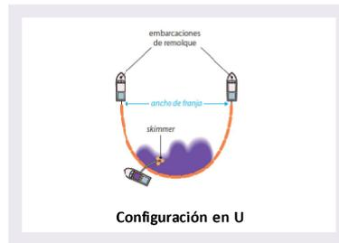
Dos embarcaciones pueden remolcar una barrera en forma de **U** dejándose llevar por la corriente, manteniéndose en posición estacionaria, o avanzado aguas arriba hacia la fuente del derrame.
