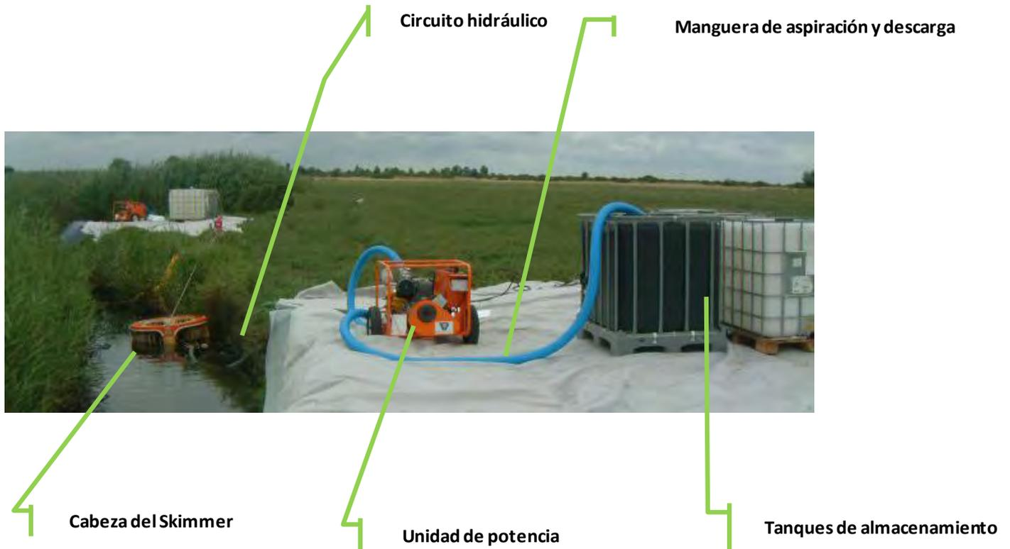
Para recuperación en costa se emplean en el límite del agua o en la playa. No es eficaz cuando el petróleo es muy viscoso. Según su principio de funcionamiento, los skimmers pueden ser oleófilicos, de vertedero, mecánicos y de vacío.
