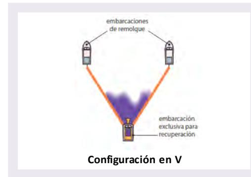
La barrera se puede desplegar en forma de **V**, utilizando 3 embarcaciones. La tercera embarcación se coloca en el ápice de la barrera y sirve para recuperar el hidrocarburo derramado.
