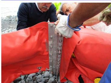
Las barreras se enlazan unas con otras hasta alcanzar la longitud deseada.
