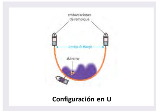
Dos embarcaciones pueden remolcar una barrera en forma de **U** dejándose llevar por la corriente, manteniéndose en posición estacionaria, o avanzando aguas arriba hacia la fuente del derrame.
