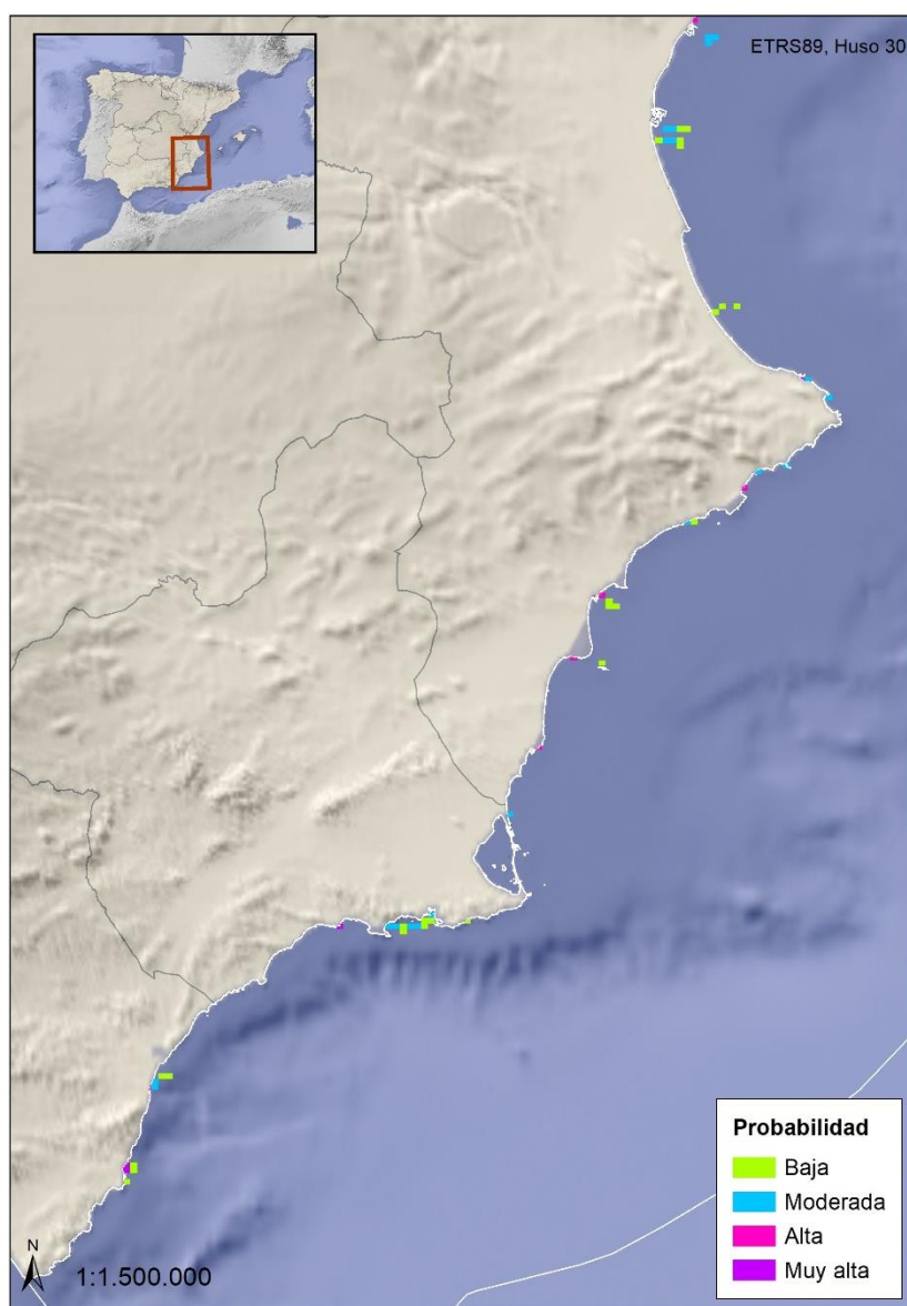
Figura 2. Ubicación de las zonas del fondo marino perturbadas por fondeo según la probabilidad de perturbación en la parte sur de la Demarcación levantino-balear (Fuente: Figura elaborada por el CEDEX a partir de los datos AIS de SASEMAR).
