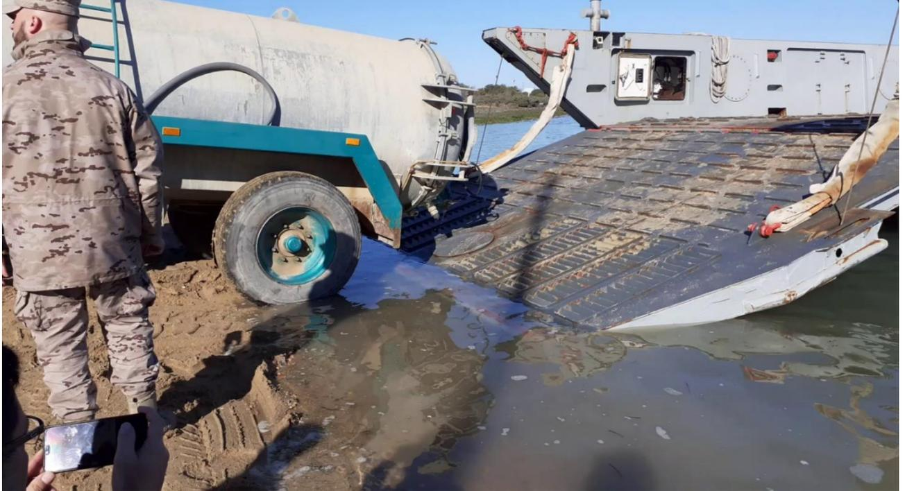
*Ilustración 17. Pruebas de embarque del tractor con cuba a remolque.*
