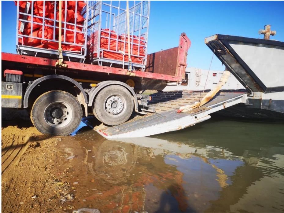
*Ilustración 12 Pruebas de embarque con el camión volquete.*
