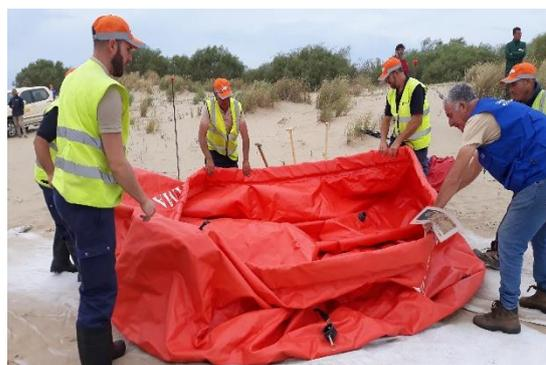
*Ilustración 4. Tanque autoportante.*
