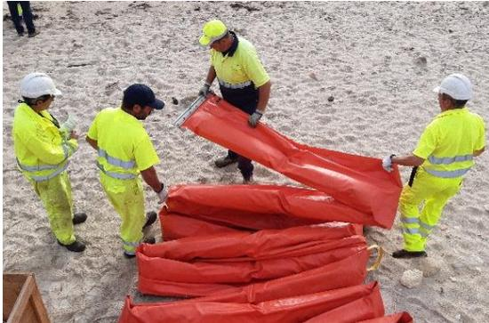
Ilustración 7. Barrera de contención cilíndrica.
