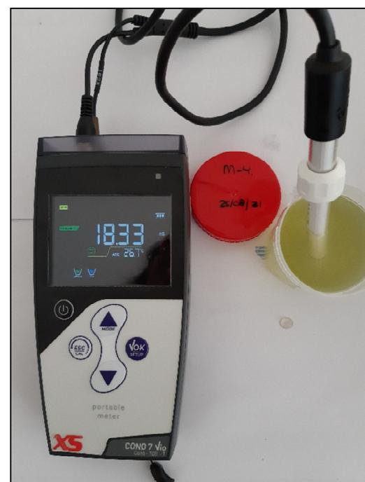
La conductividad o capacidad del agua para conducir la corriente eléctrica aumenta rápidamente con la cantidad de iones disueltos en la misma. Es un parámetro importante y de fácil medida que indica la salinidad de las muestras.
