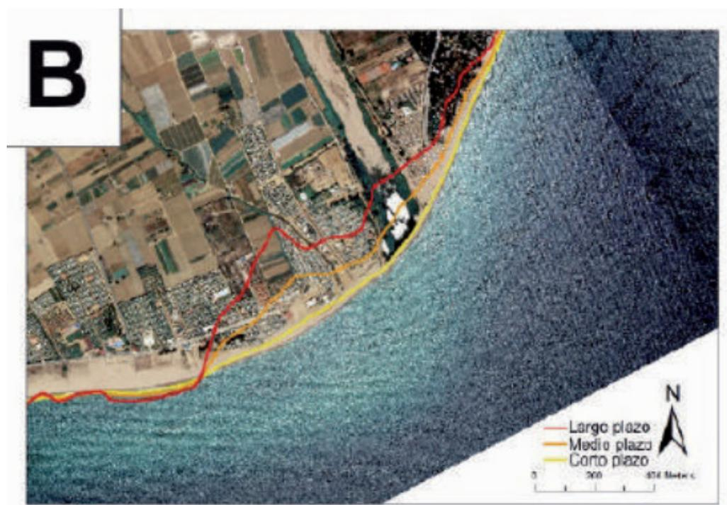
**Ilustración 22.** Secuencia de fotografías con los escenarios futuros de línea de costa en base a la dinámica del año 2006 proyectados para los años 2011 (amarillo), 2031 (naranja) y 2056 (rojo) en la zona de la desembocadura del río (Delta y Punta de la Tordera). Fuente: *Consecuencias a Largo Plazo de la Gestión Desintegrada en Zonas Costeras: el Caso del Delta de la Tordera (Cataluña, España)* Enric Sagristà, Rafael Sardá y Jordi Serra. Diciembre de 2018.
