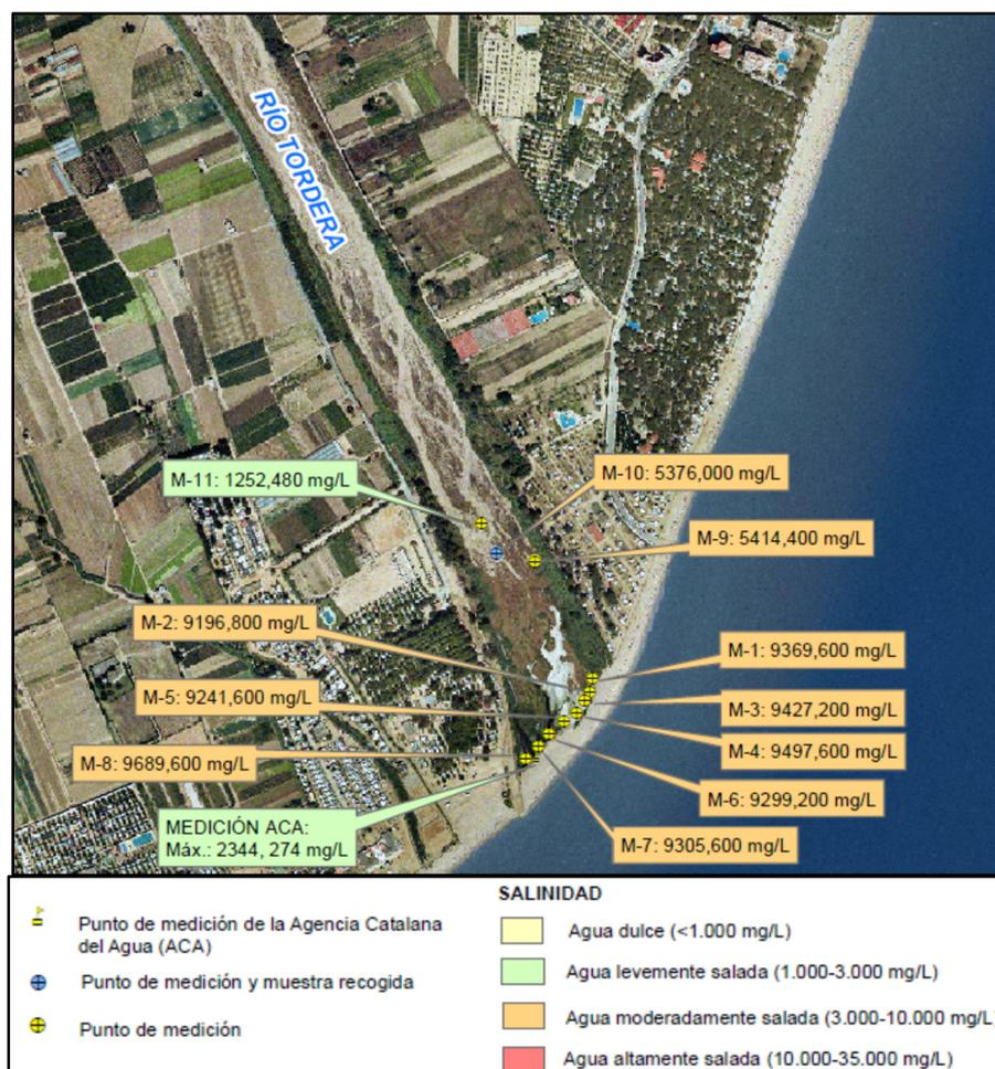
**Ilustración 28.** Puntos de medición y valores de salinidad de la campaña de campo realizada en junio de 2006 para el “Estudio de salinidad en la desembocadura del río Tordera. T.M. Blanes (Girona)” elaborado por Tragsatec.
