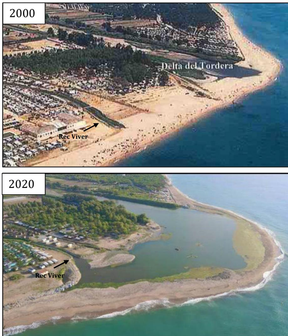
**Ilustración 12.** Comparativa entre los años 2000 y 2020 de la masa de agua permanente o laguna litoral que se forma junto a la barra de la desembocadura. Fuente: Imagen superior, fotograma del vuelo oblicuo de la entonces Dirección General de Costas del año 2000; imagen inferior, blogs.publico.es.
