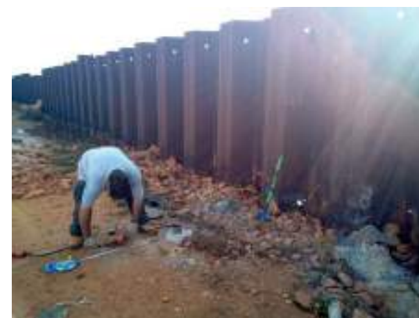
Foto 5.- Imagen de la realización del ensayo de sísmica paralela SP-4 .
