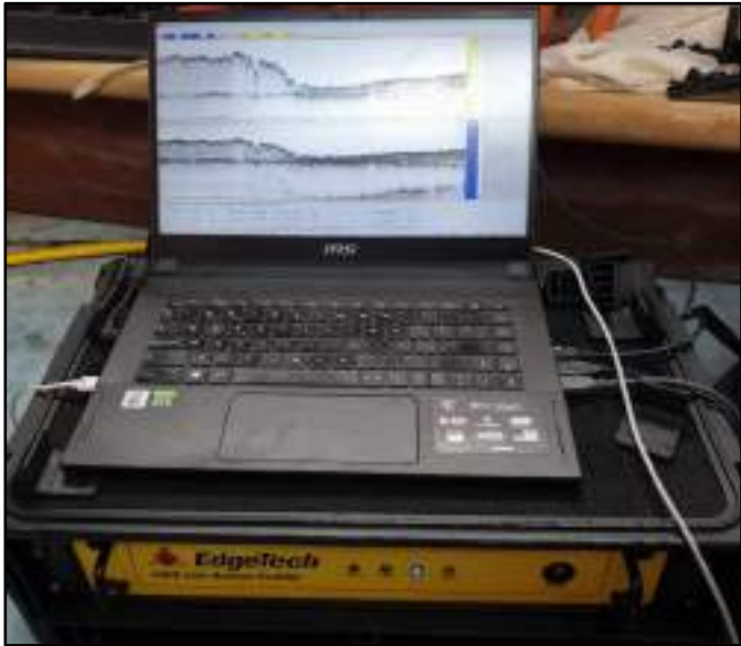
Fig. 12: Perfilador sísmico Chirp Edgetech 3400 durante la toma de datos
