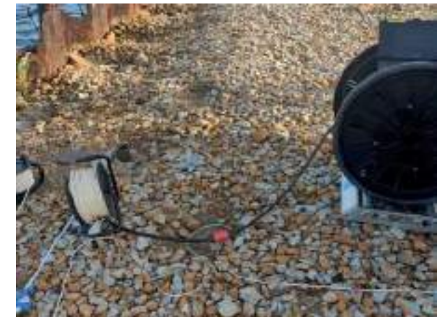
Foto 2.- Imagen de la realización del ensayo de sísmica paralela SP-2 .
