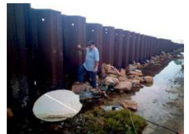
Foto 6.- Imagen de la realización del ensayo de sísmica paralela SP-5 .
