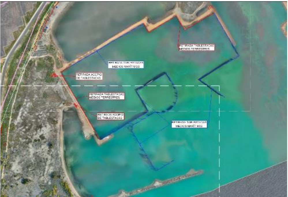
Ilustración 3. Tablestacado existente a retirar
