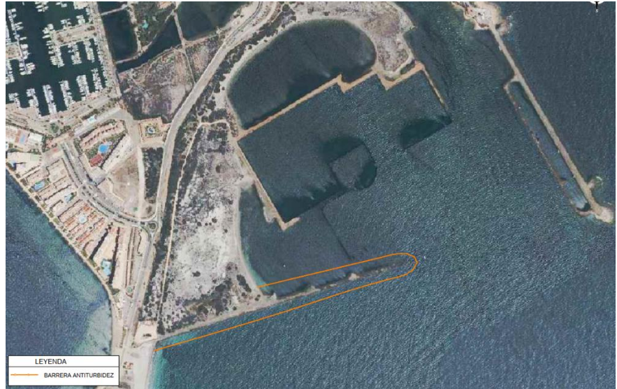
Ilustración 92. Barrera antiturbidez actuaciones en el espigón Sur
