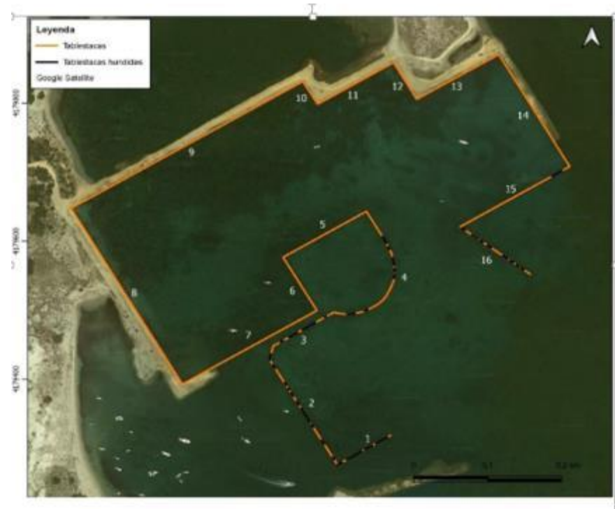
Ilustración 2. Diferentes secciones de inspección realizadas en tablestacas
