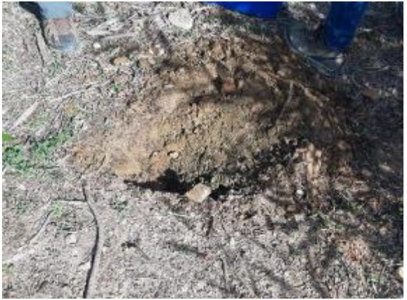
Imagen 10. Materiales superficiales de relleno junto a la calicata 3 (punto T-04)
