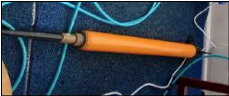
Fig. 13: Sensor del magnetómetro
