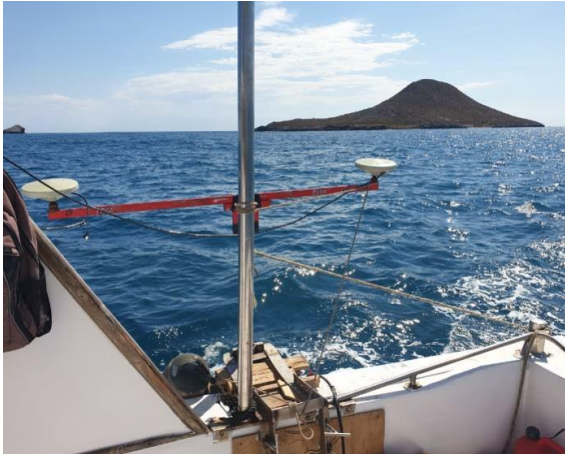
Figura 12. Transductor y sistema de posicionamiento instalado en la embarcación.
