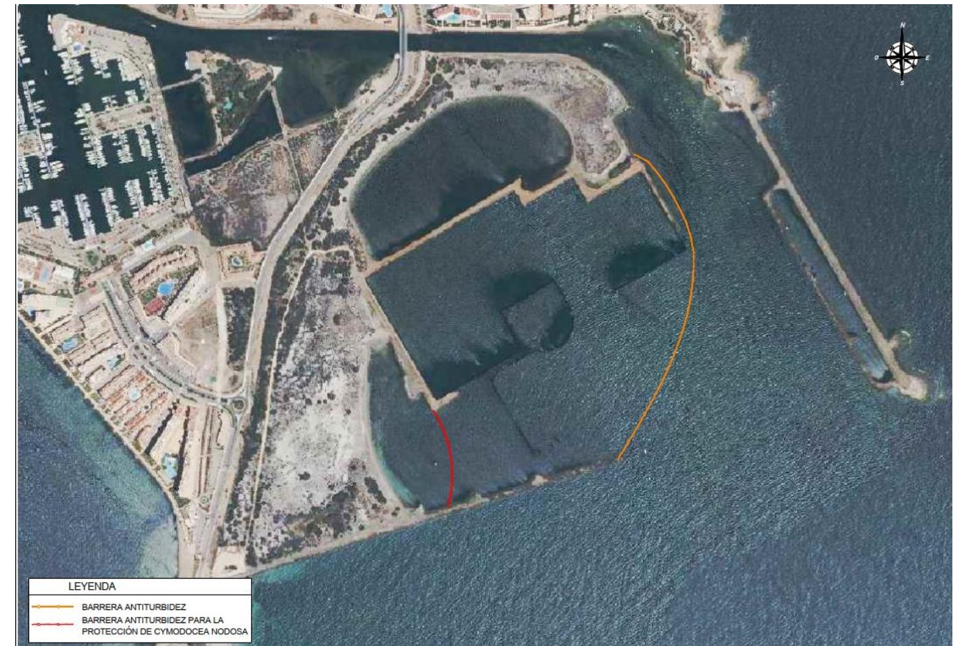
Figura 3. Barrera antiturbidez retirada tablestacado marítimo
