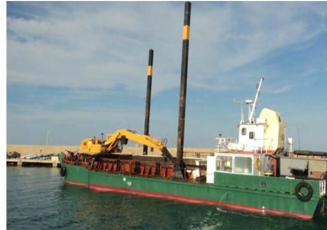
Figura 17 Transporte pontona contenedor y maquinaria excavación sobre pontona
