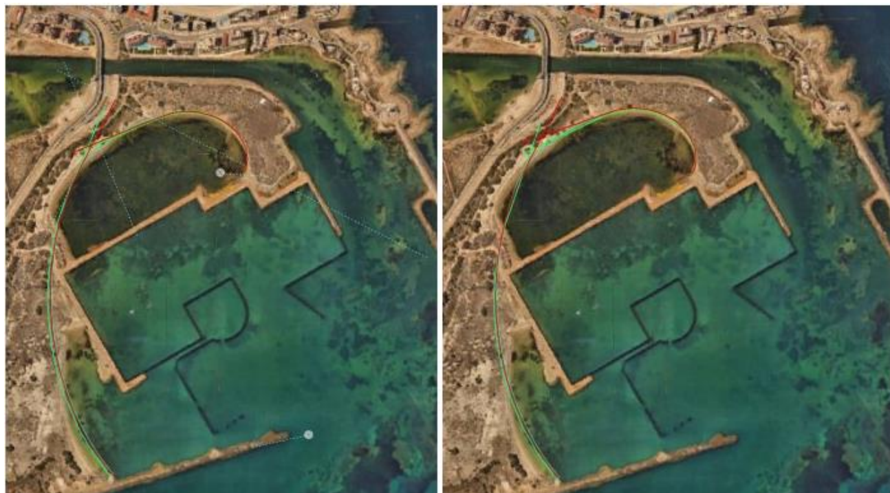
Figura 7 Formas en planta actual (azul), para el intervalo de confianza del 5% (verde) e intervalo de confianza de 95% (rojo) de la alternativa 1 en el RCP 4.5 (derecha) y el RCP 8.5 (izquierda)
