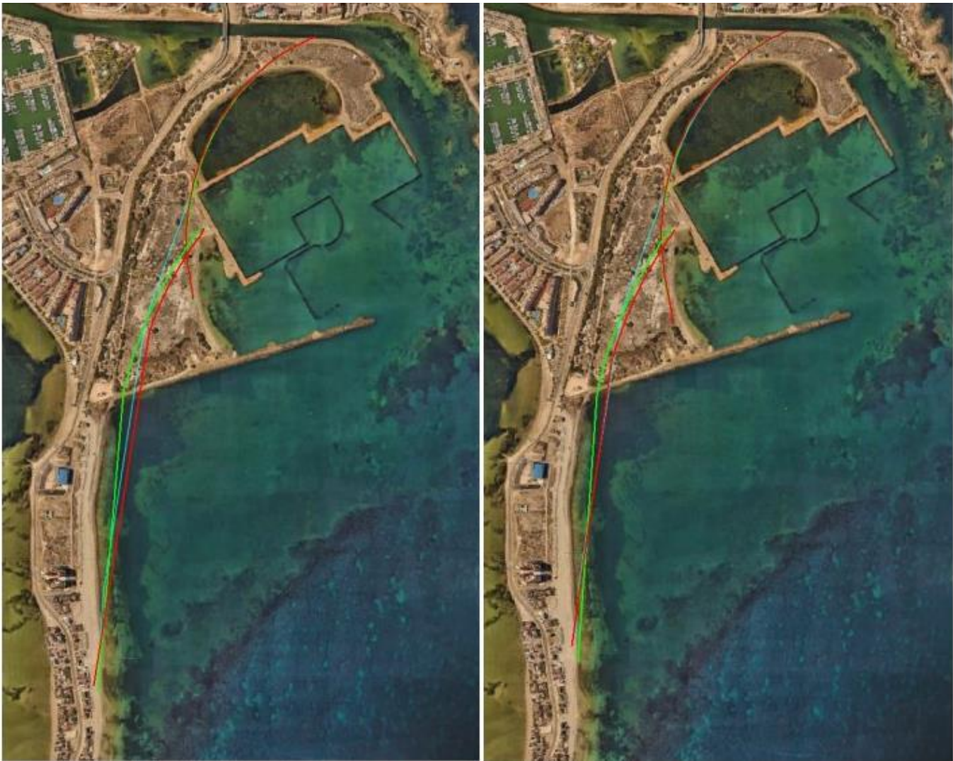
Figura 9 Formas en planta actual (azul), para el intervalo de confianza del 5% (verde) e intervalo de confianza de 95% (rojo) de la alternativa 3 en el RCP 4.5 (derecha) y el RCP 8.5 (izquierda)
