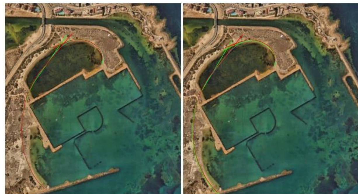
Figura 8 Formas en planta actual (azul), para el intervalo de confianza del 5% (verde) e intervalo de confianza de 95% (rojo) de la alternativa 2 en el RCP 4.5 (derecha) y el RCP 8.5 (izquierda)
