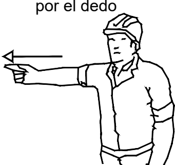
10 Bajar el aguilón o pluma y levantar la carga 11 Girar el aguilón en la dirección indicada por el dedo 12 Avanzar en la dirección indicada por el señalista
