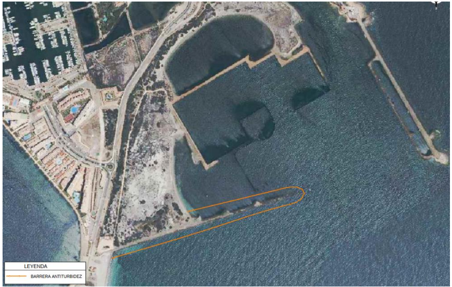
Figura 11. Barrera antiturbidez actuaciones en el espigón Sur
