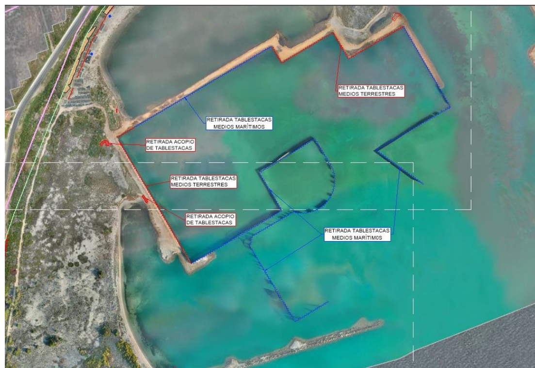
Figura 2. Tablestacado existente a retirar
