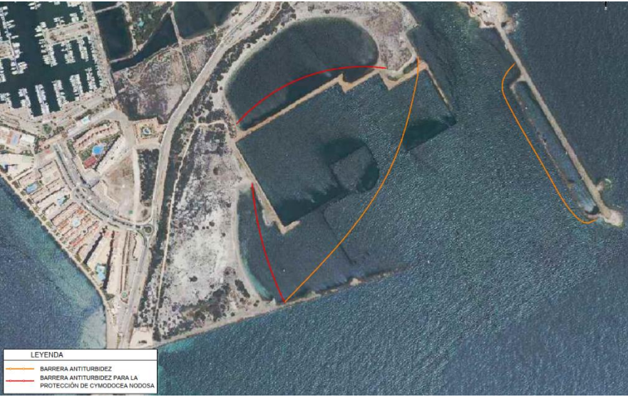
Figura 10. Barrera antiturbidez fase obra dique de Levante a retirar
