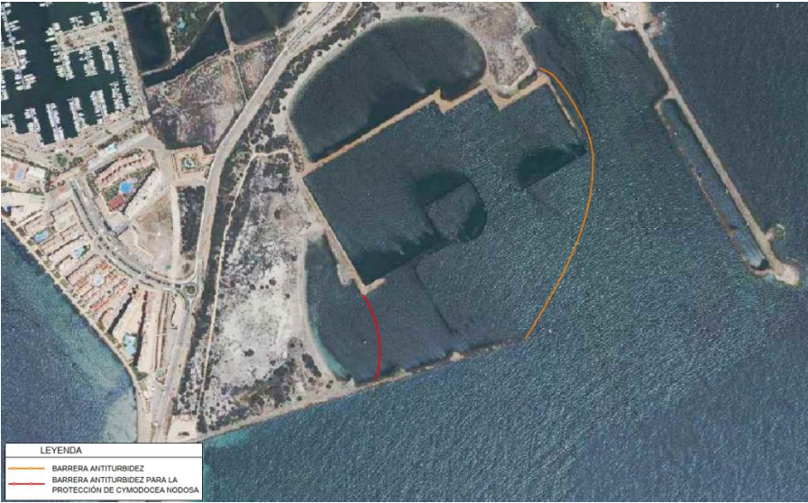
Figura 8. Barrera antiturbidez retirada tablestacado marítimo
