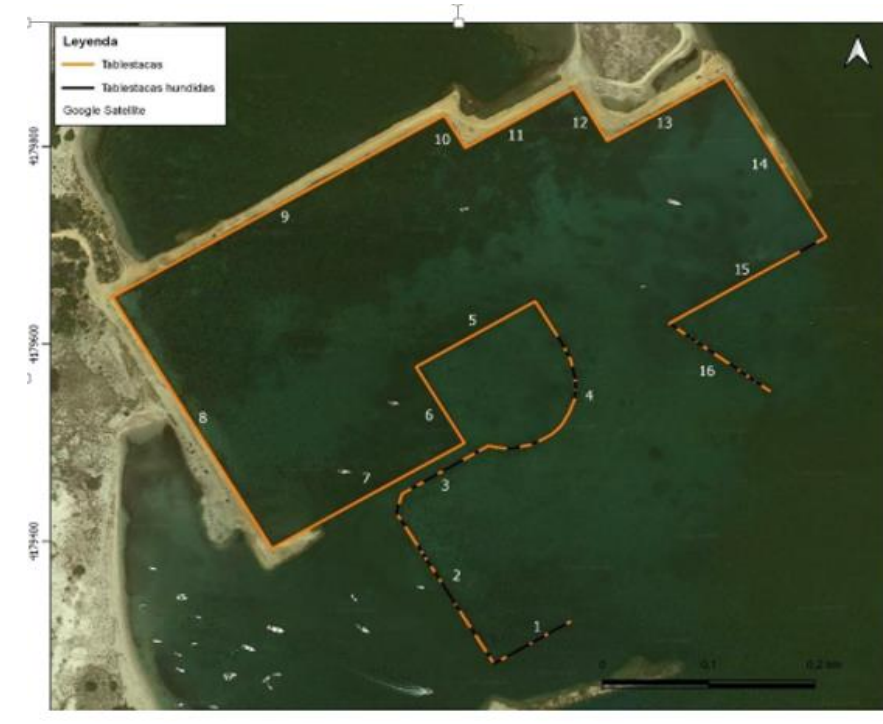
Figura 4 Diferentes secciones de inspección realizadas en tablestacas
