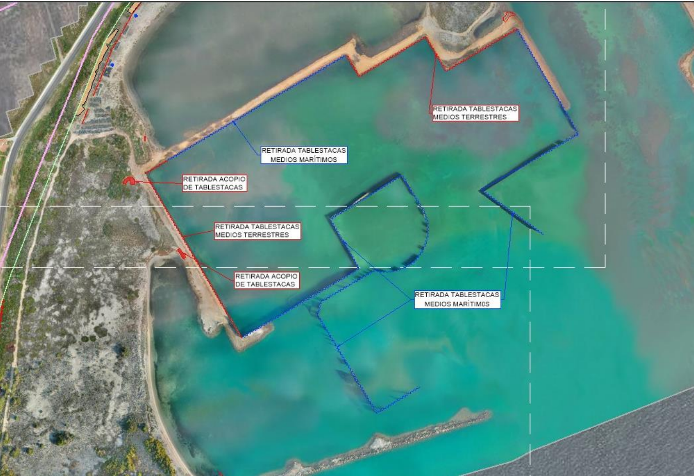
Figura 57. Tablestacado existente a retirar
