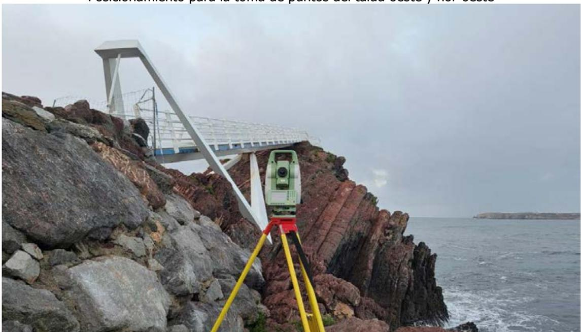
Posicionamiento para la toma de puntos del talud este
