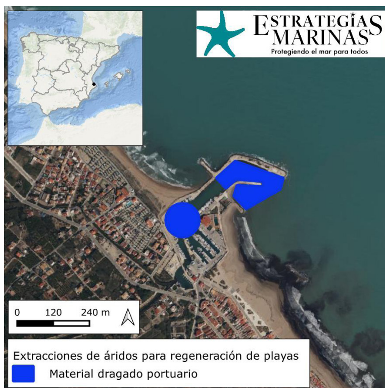
Figura 28. Detalle de la extracción de áridos en el puerto de Oliva (Valencia) para la regeneración de playas. (Fuente: Figura elaborada por el CEDEX a partir de datos del MITECO)
