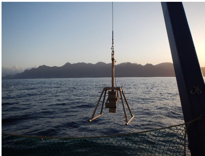
Figura 55. Lanzamiento de box corer durante la campaña CIRCAN 2020. Fuente: COC (IEO-CSIC).
