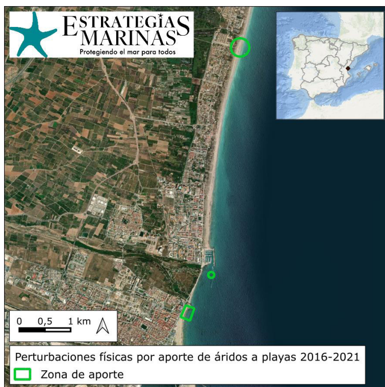
Figura 25. Zonas de vertido para la regeneración de las playas del norte de la ciudad de Valencia y Sagunto. (Fuente: Figura elaborada por el CEDEX a partir del Inventario de extracciones de áridos para aporte a playas en España)
