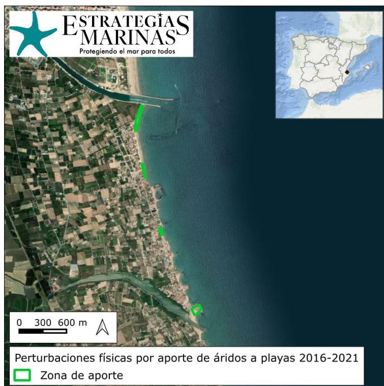
Figura 26. Zonas de vertido para la regeneración de las playas de Cullera (Valencia). (Fuente: Figura elaborada por el CEDEX a partir del Inventario de extracciones de áridos para aporte a playas en España)
