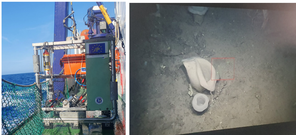
Figura 38. Trineo fotogramétrico TASIFE 2013 y ejemplo de adquisición de imágenes submarinas en tiempo real durante el transcurso de la campaña CIRCASUR 2023.
