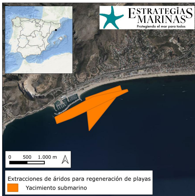
Figura 27. Detalle de la extracción de áridos en el yacimiento frente a la costa de Barcelona para la regeneración de playas. (Fuente: Figura elaborada por el CEDEX a partir de datos del MITECO)
