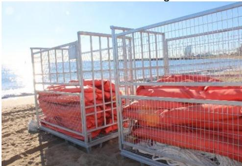
**Ilustración 5.** Barreras selladoras y cilíndricas.
