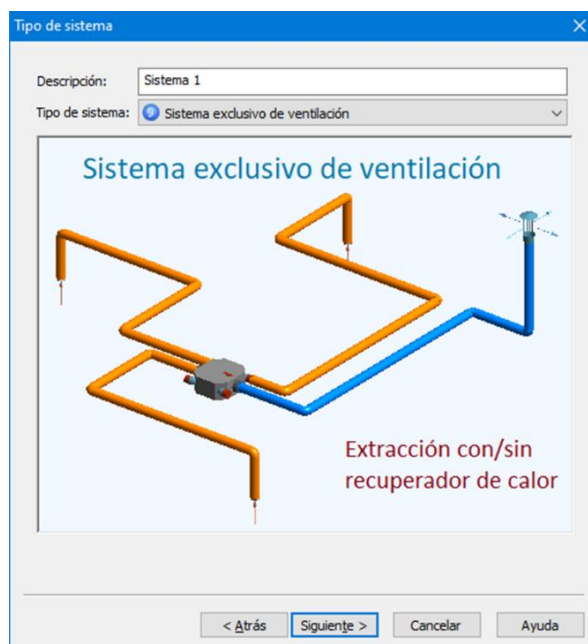
Ilustración 56. Selección de sistema de tipo ventilación exclusivo.
