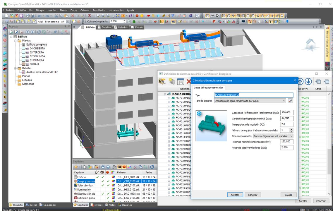
El sistema denominado **Calefacción multizona por agua** ha sido ampliado y renombrado para abarcar también los sistemas de refrigeración por agua. Ahora se llama **Climatización multizona por agua**, reflejando de manera más precisa su funcionalidad integral.
