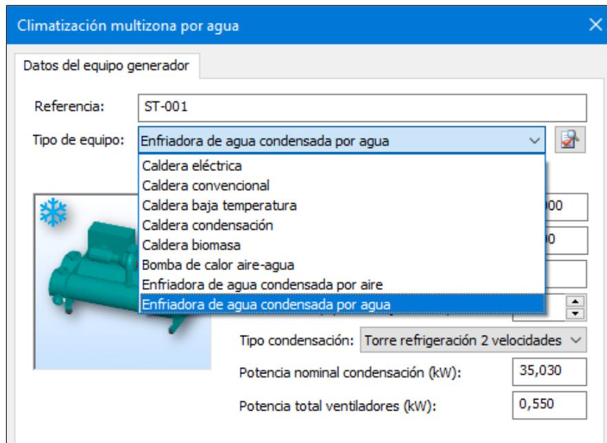
Si se elige una **Enfriadora de agua condensada por agua**, es posible seleccionar el equipo de disipación térmica. Las opciones disponibles incluyen **torres de refrigeración** con diferentes sistemas de regulación:
