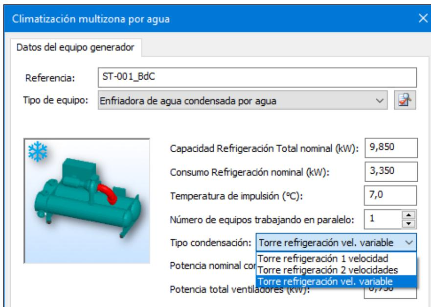
Los parámetros de simulación de la torre de refrigeración se definen también en la solapa del sistema **Enfriadora de agua condensada por agua**, y corresponden a la potencia nominal de condensación y al consumo eléctrico del total de los ventiladores.
