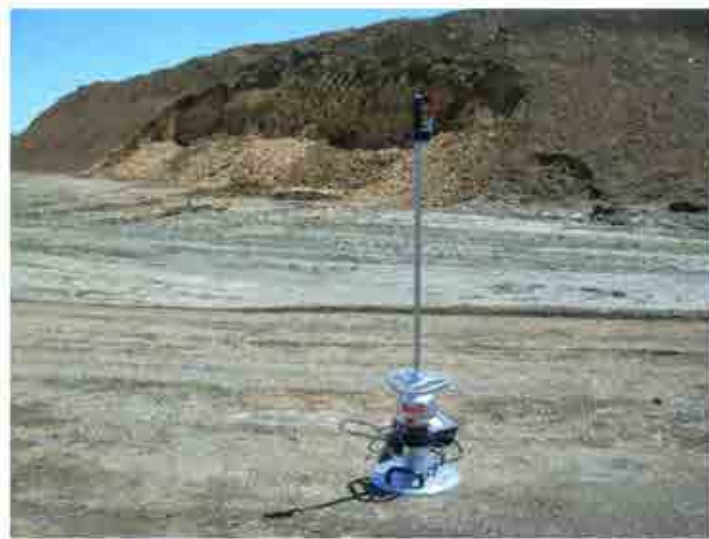
Fotografía 18. Ensayo de carga vertical en suelos mediante placa dinámica.
