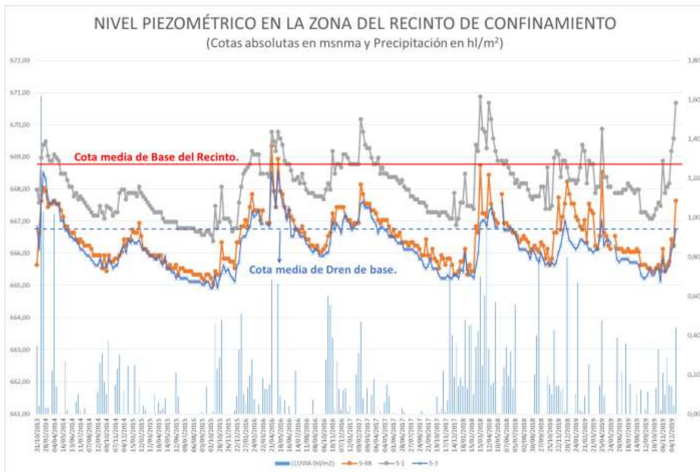
Figura A.1.9. Gráfica de niveles piezométricos, del Recinto y del Dren de base proyectado hasta dic-2019.
