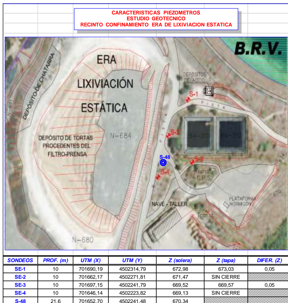
Figura A.1.8. Situación de los sondeos geotécnicos perforados en la zona del Recinto de Confinamiento.
