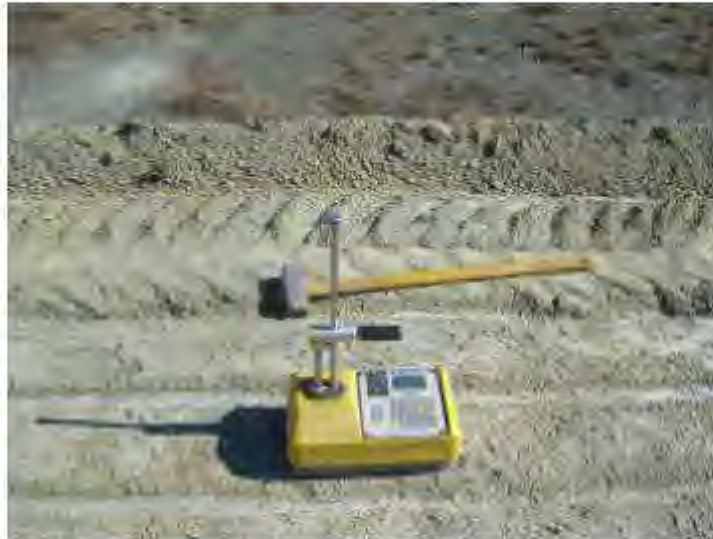
Fotografía 19. Ensayo nuclear para determinar la densidad y humedad “in situ” de un suelo. Marca “Troxler”.
