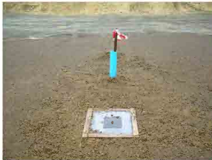
Fotografía 17. Hito de nivelación junto a la terminación de la placa de asiento.
