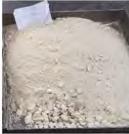
Fotografía 16. Material de torta tratado con el 2 % de cal.
