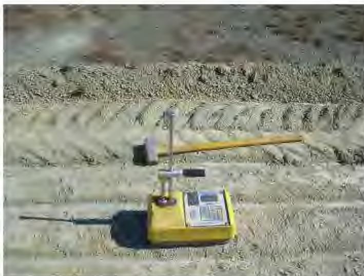
Fotografía 7. Ensayo nuclear para determinar la densidad y humedad “in situ” de un suelo. Marca “Troxler”.
