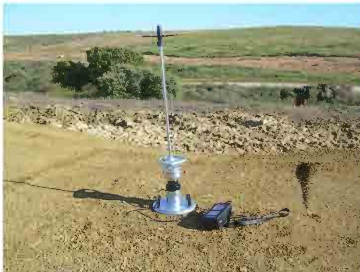
Fotografía 9. Placa de carga realizada sobre primera tongada (Terraplén de prueba A).
