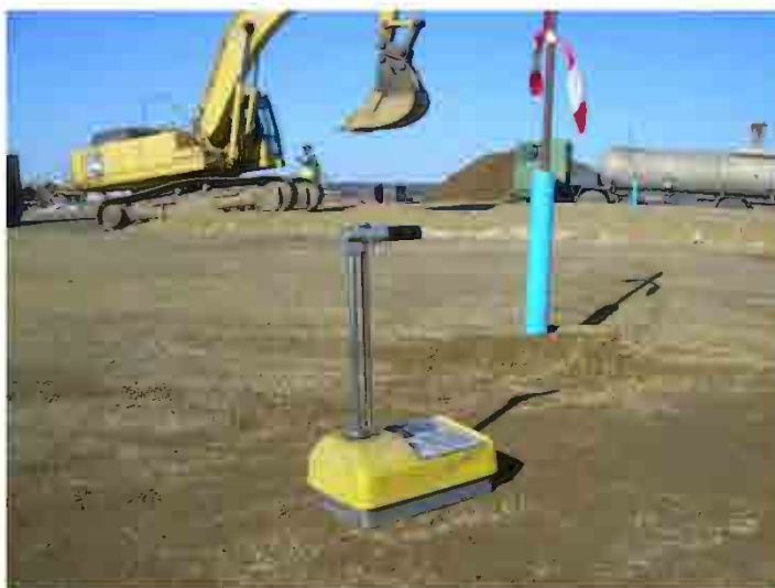
Fotografía 9. Placa de carga realizada sobre primera tongada (Terraplén de prueba A).
