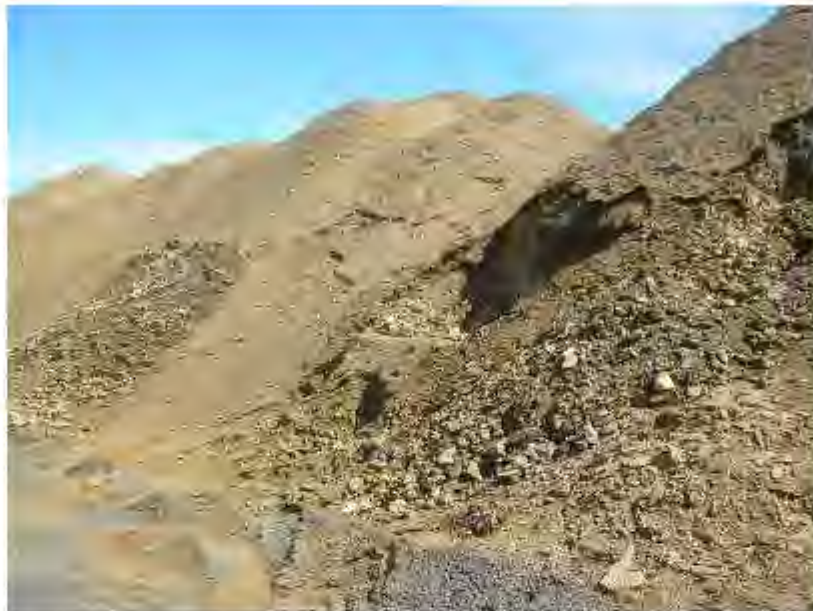
Fotografía 5. Detalle de acopio reciente de tortas de neutralización (torta nueva) en el que resultó inviable transitar con la retroexcavadora. Parte norte de la Era.
