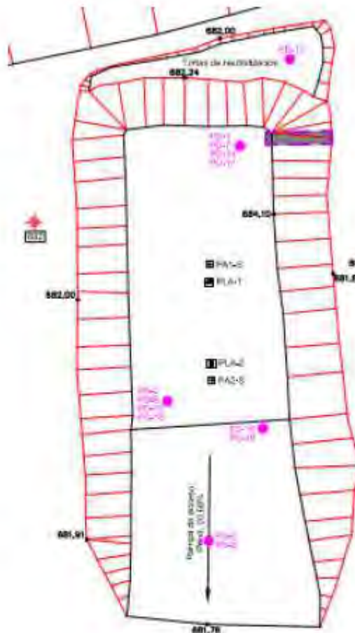
Figura 5. Configuración del terraplén de prueba A.
