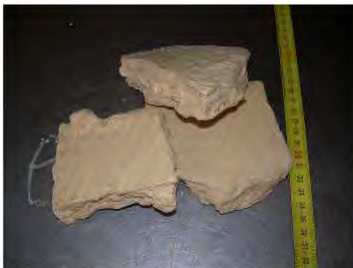
Fotografía 9. Detalle de la torta original a su salida del filtro prensa con alto contenido en humedad.
