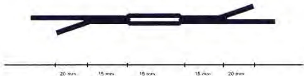
Figura A.4.4.- Dimensiones mínimas de la soldadura doble
