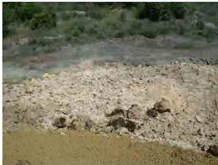
Fotografía 24 Aspecto de desecación parcial del material de torta en 24 h. Zona norte del terraplén A donde se ejecuto el ensayo de placa de carga PD-13.
