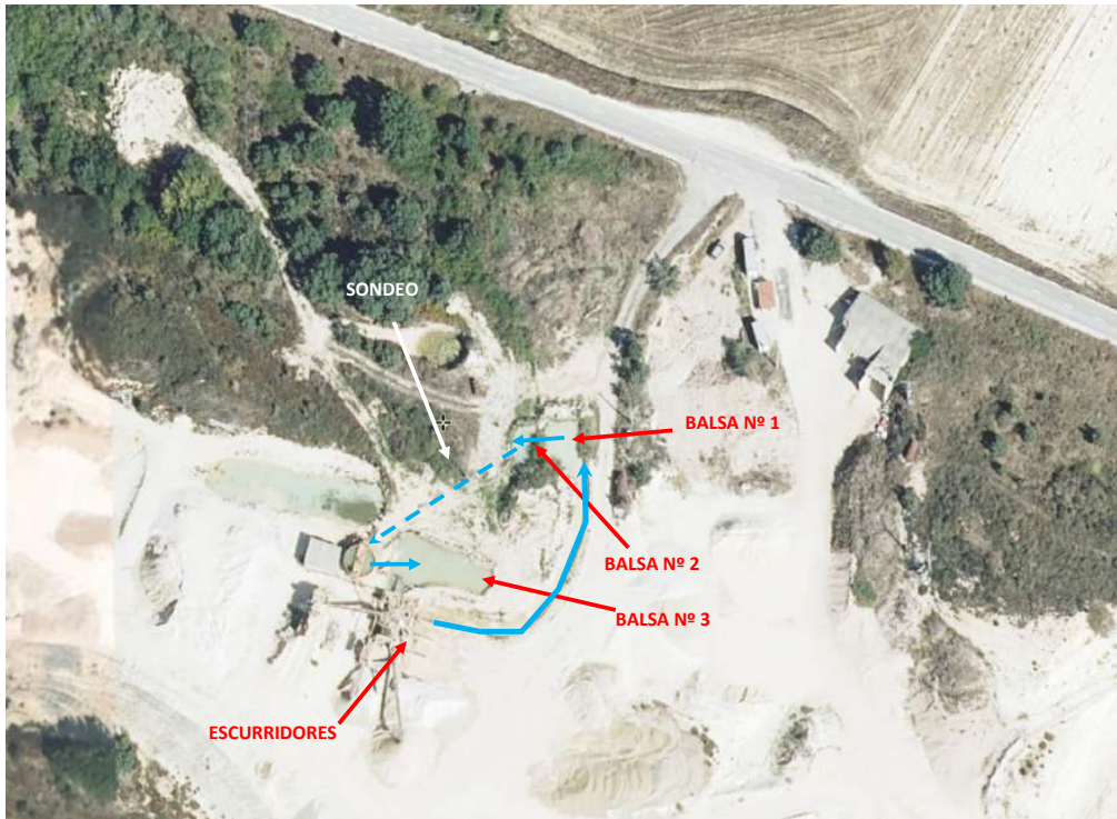
Ilustración 1.- Circuito del agua del proceso de lavado
