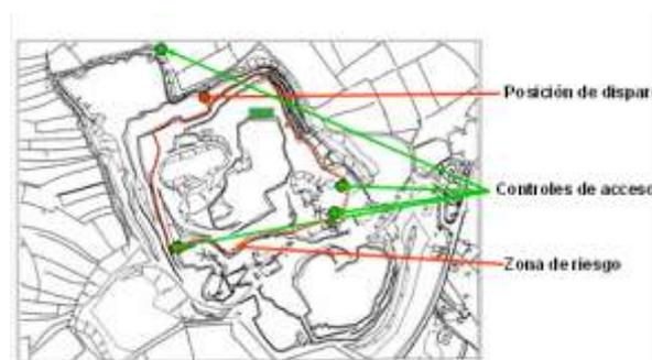
Figura 67: Plano de la explotación con los elementos principales de acceso y zona de peligro
