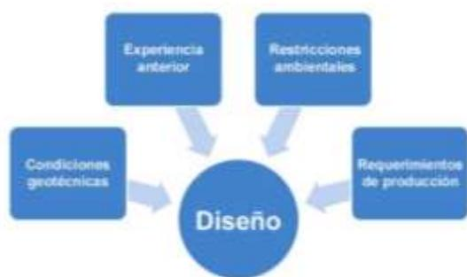
Figura 33: Tipos de condicionantes a un diseño de voladura
