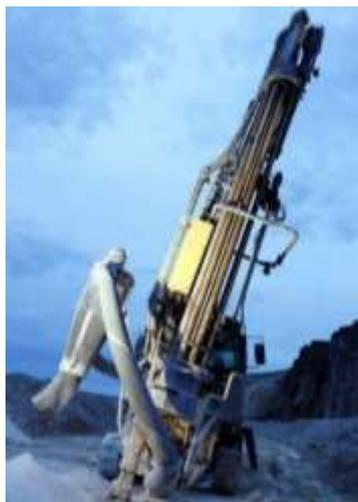
Figura 37: Carro de perforación de martillo en fondo
