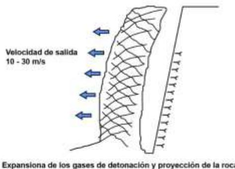
Expansión de los gases de detonación y proyección de la roca
