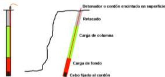
Figura 21: Esquema de iniciación en superficie
