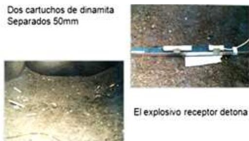
Figura 5: Ensayo al aire de un explosivo altamente sensible (dinamita)
