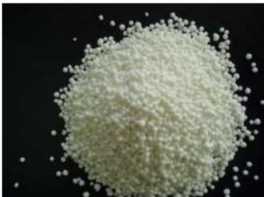
Figura 11: Aspecto de prill de nitrato amónico usado en la fabricación de ANFO
