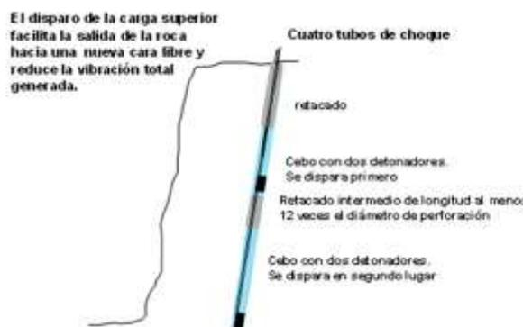
Figura 81: Cargas partidas en un barreno para reducir la carga operante (MIC)
