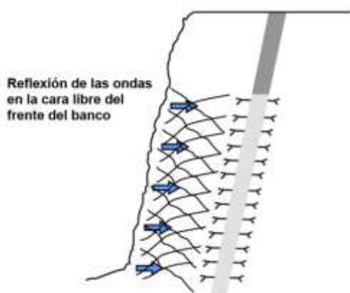
Figura 46: Reflexión de las ondas en la cara libre del frente del banco
