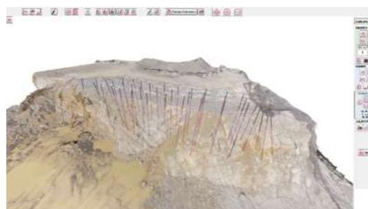
Figura 38: Modelo tridimensional de un frente de voladura
