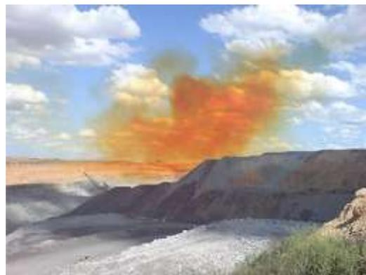
Figura 8: Humos de color naranja tras el disparo de una voladura, característicos de una detonación incompleta
