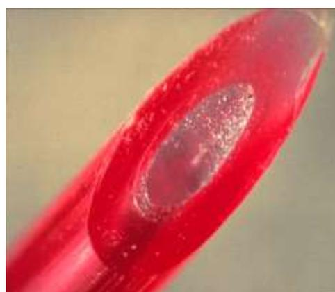
Figura 15: Sección de un tubo de choque
