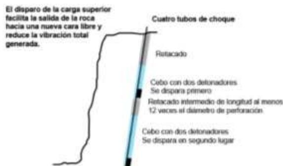
Figura 52: Disposición de carga y secuenciación en barrenos con cargas partidas
