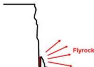
Figura 65: Proyecciones generadas por el disparo de un barreno corto en el pie del banco
