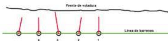
Figura 40: Influencia del azimut en el espaciamiento entre barrenos
