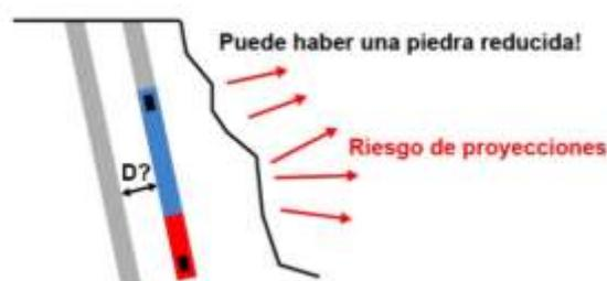
Figura 77: Esquema de perforación de un barreno paralelo
