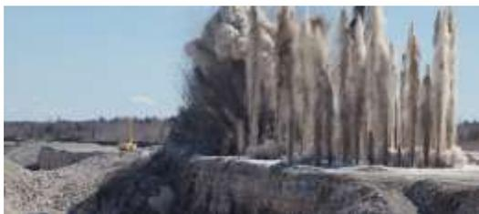
Figura 22: Barrenos iniciados en superficie. Se aprecia el efecto negativo de la rotura del retacado
