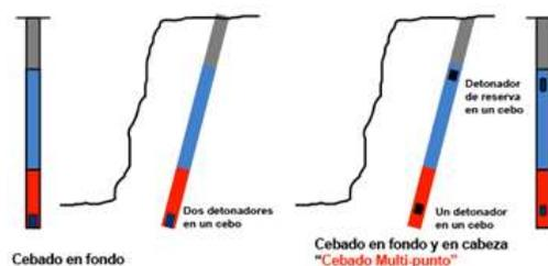
Figura 24: Esquema de iniciación en fondo de barreno
