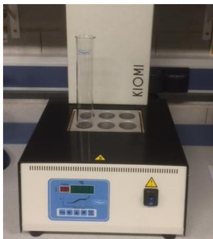
Figura 5: Aparato ensayo de temperatura de descomposición
