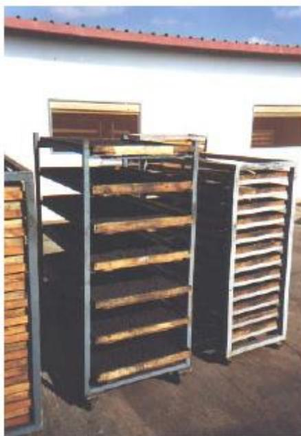
Figura 35: Secado al sol en bandejas de mezclas de color
