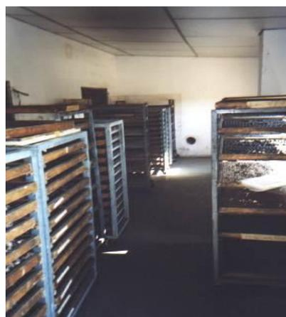
Figura 50: Bandejas en cámara de secado
