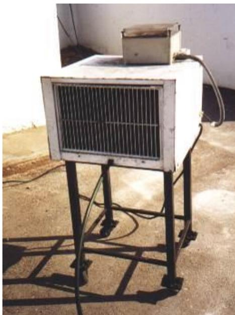
**Figura 33: Equipo de deshumificación por frío**
