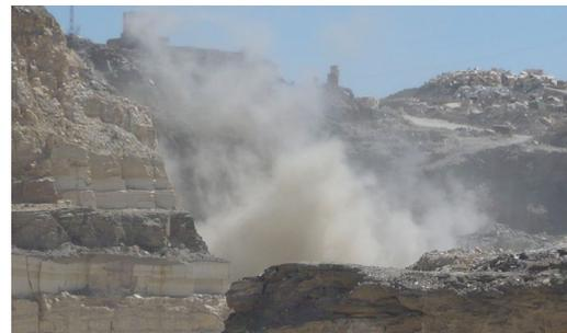
**Figs.** Para evitar la puesta en suspensión de polvo en voladuras, el retacado debe hacerse sin utilizar detritos. Más importante aún suele ser evitar que el polvo acumulado en la superficie del entorno de voladura acceda al ambiente, para lo cual puede regarse dicho entorno, siempre que el explosivo utilizado lo permita.
