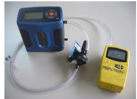
Fig. Bomba ciclón y calibrador
