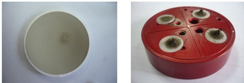
**Fig.** Substratos y membrana en impactadores tras la toma de muestras que permiten observar el método de clasificación en que se basan.
