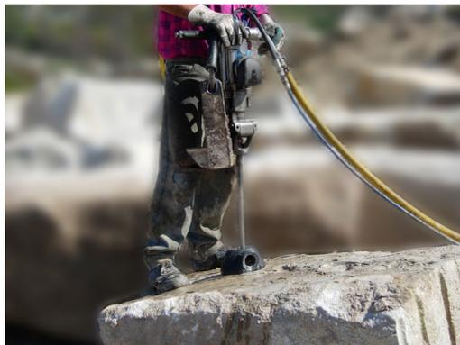
**Fig.** Perforación manual con uso de agua
