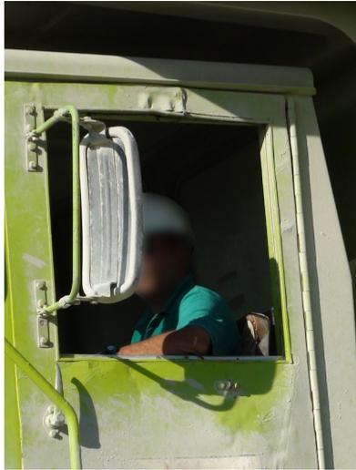
**Fig.** Las cabinas deben estar cerradas y contar con el grado de confort adecuado para evitar la apertura de ventanillas. Deben existir especificaciones para el operario, con el fin de que mantenga unos hábitos adecuados, como son la limpieza de calzado al incorporarse al puesto, y la utilización de EPR cuando las abandone y esté previsto. El filtro del aire ha de contar con un mantenimiento específico y previsto para la concentración de polvo previsible en el exterior.
