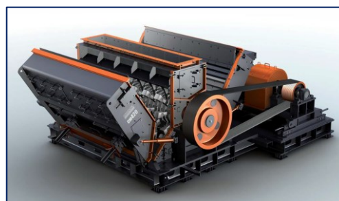
Ilustración 6-50 Sistema De Accionamiento Usual Triturador De Martillo: Correa Y Polea. Fuente: Sandvik
