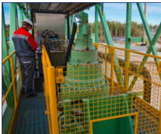
Ilustración 6-89 Resguardo De Distancia Unidad Accionamiento Tanque Espesador. Fuente: Outotec
