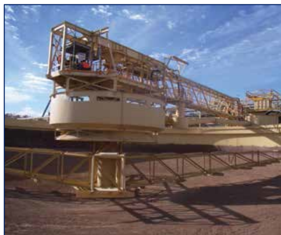
Ilustración 6-86 Brazos Racletas Con Cabeza De Mando En Apoyo De Tanque Espesador
