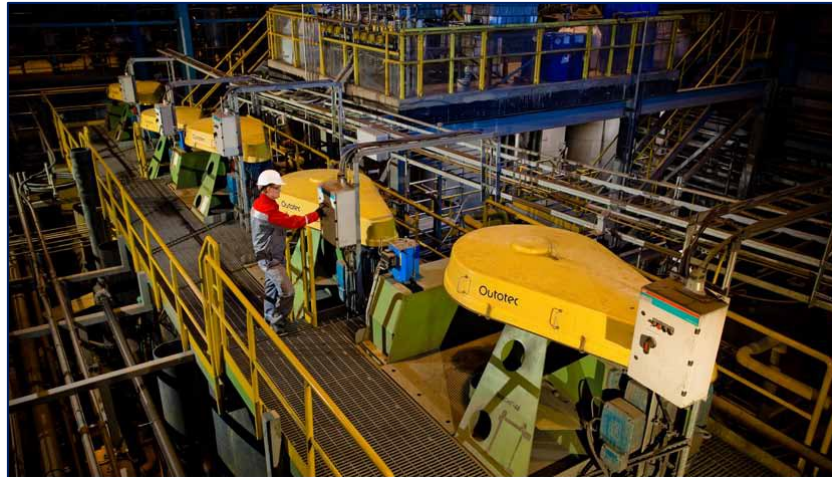
Ilustración 6-104 Resguardos (Elementos Transmisión, Contra Proyecciones De Partes) Y Medios De Acceso En Celda Flotación. Fuente Outotec
