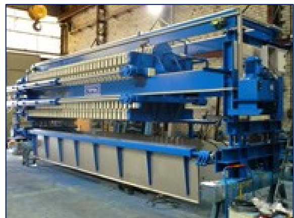
Ilustración 6-95 Filtro Prensa Horizontal De Barras Laterales, Y Cierre Por Cilindros Hidráulicos Laterales
