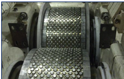
Ilustración 6-44 Cilindros De Triturador De Alta Presión Con Camisas De Botones De Alta Dureza. Fuente: Metso
