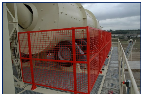
Ilustración 6-67 Resguardo Fijo De Distancia Para Equipo Trómel L
