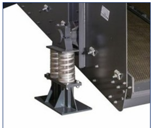
Ilustración 6-77 Puntos De Apoyo Y Muelles Criba Enfundados. Fuente: Sandvik
