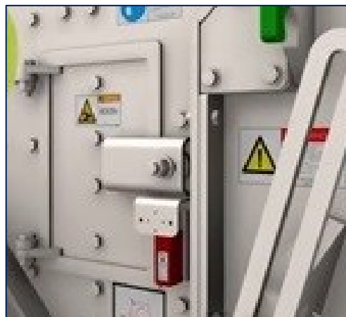
Ilustración 6-51 Panel De Inspección En Triturador De Impactos Secundario, Con Bloqueo Y Enclavamiento. Fuente: Metso
