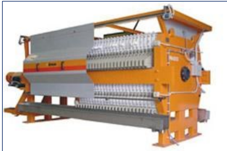
Ilustración 6-97 Filtro Prensa Con Configuración Cerrada (Resguardo Con Enclavamiento). Fuente: Toro
