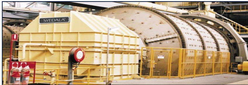
Ilustración 6-62 Resguardo De Distancia Con Dispositivo De Enclavamiento En Puerta Para Equipo De Molienda. Fuente: Metso
