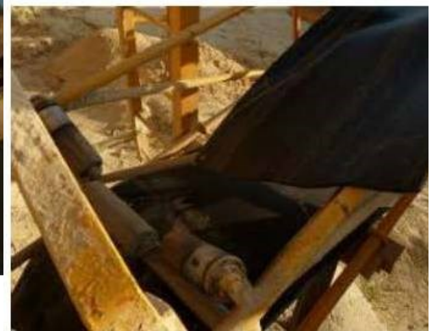
Ilustración 7-7 Vistas Lugar Accidente En Tambor De Retorno De Cinta Transportadora
