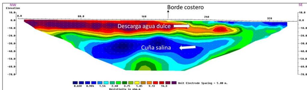
Figura 37. Perfil de tomografía eléctrica que muestra la entrada de agua procedente del acuífero en el Mar Menor.
