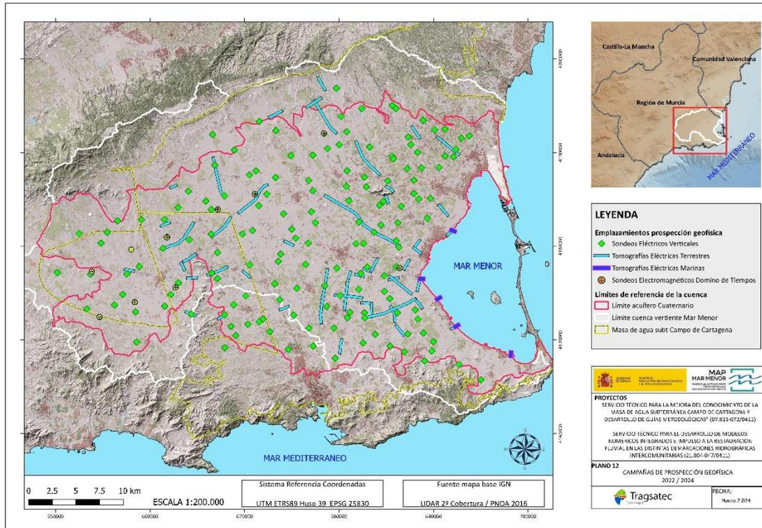
Figura 36. Sondeos Eléctrico Verticales (SEVs) y tomografías eléctricas ejecutados hasta la fecha.
