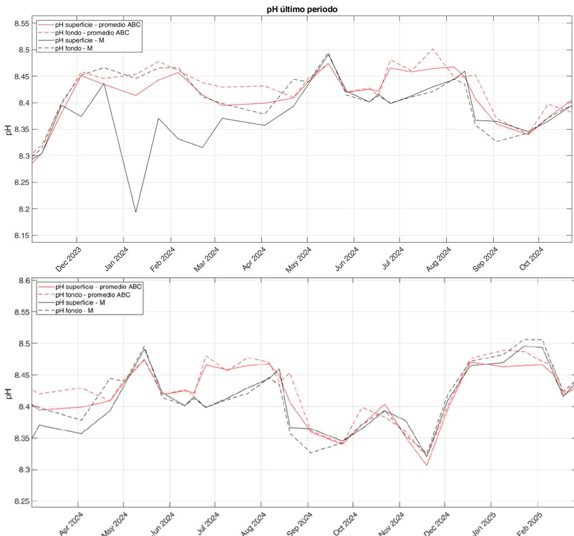
Figura 3. Valores de pH superficial (0,5m; línea continua) y pH del fondo (entre 4 y 6m dependiendo de la estación, línea discontinua) de los muestreos del proyecto DMMEM y BELICH en las estaciones de muestreo A, B, C y M de la laguna del Mar Menor durante el último año natural.
