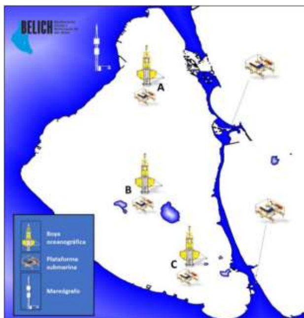
Figura 2. Esquema de los componentes del sistema de monitorización: un mareógrafo, una estación meteorológica, tres boyas y cinco montes submarinos fondeados en las boyas y en las golas del Estacio y de Marchamalo.
