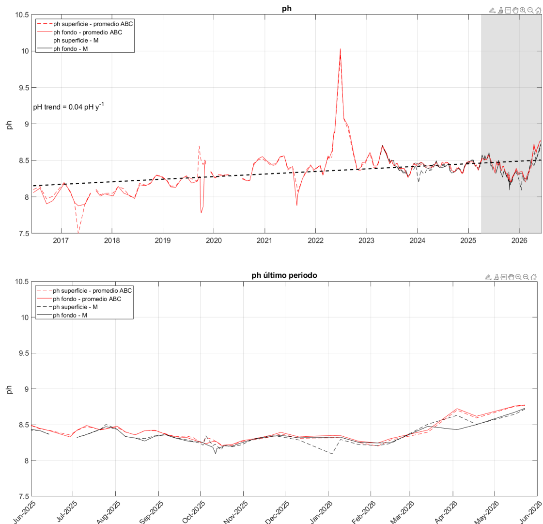
Figura 18: Valores de pH promedio en las estaciones A, B y C (líneas rojas) y en la estación M de la mancha blanca (líneas negras) (ver Figura 1). Se muestran los valores medios obtenidos en la capa superficial (0,5 m; línea discontinua) y en el fondo (línea continua). En la parte superior se muestra la serie
