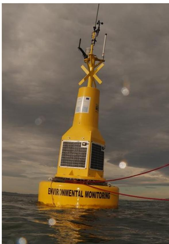
Figura 17: Boya piloto de monitorización SMARTLAGOON.
