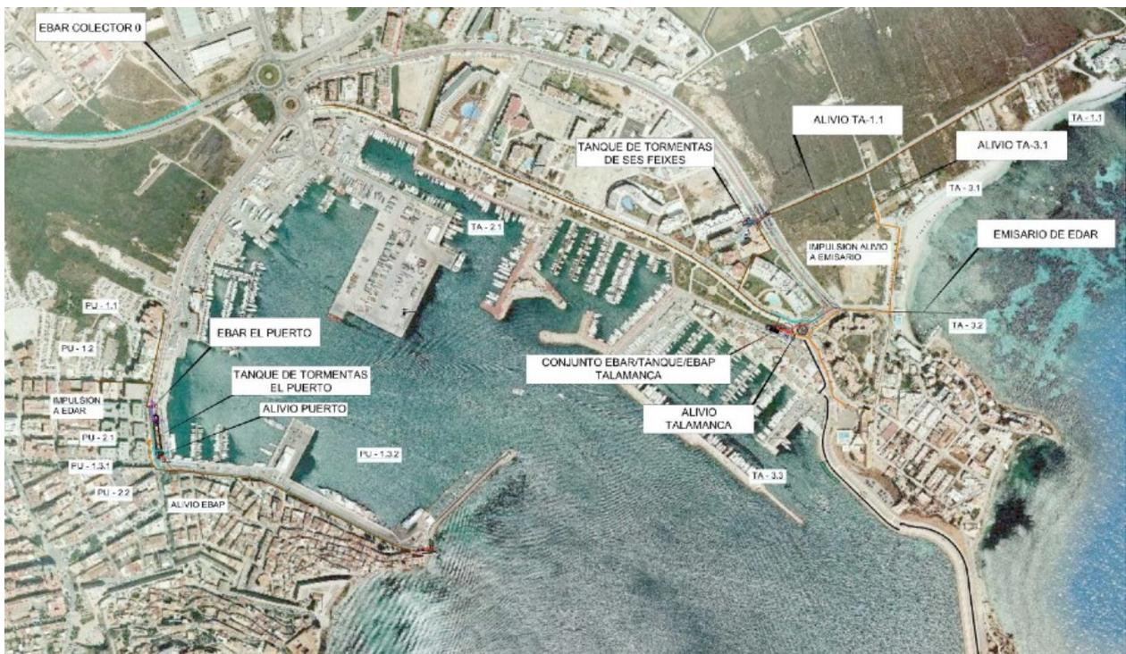
El sistema general objeto del proyecto consiste en cuatro estaciones de bombeo que vierten sus aguas a la EDAR actual y los colectores principales de llegada a estas estaciones de bombeo. Cada sistema queda formado por un grupo de colectores y su estación de bombeo correspondiente, hacia la EDAR de Ibiza.
