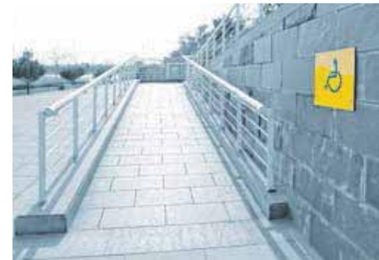
→ El trazado de las rampas será de directriz recta o ligeramente curva y la anchura libre mínima de paso en itinerarios exteriores será de 1,80 m para asegurar el cruce cómodo de dos sillas de ruedas. En rampas de acceso a edificios la anchura mínima será de 1,20 m.
