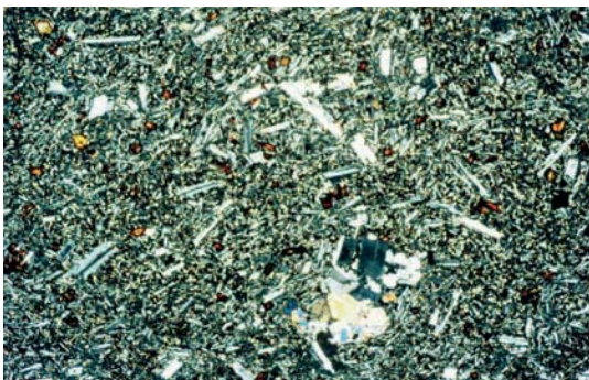
Figura 26. Basaltos-traquibasáltos vistos al microscopio. Los cristales menores de color rojizo son olivinos iddingsitizados (nícoles cruzados).
