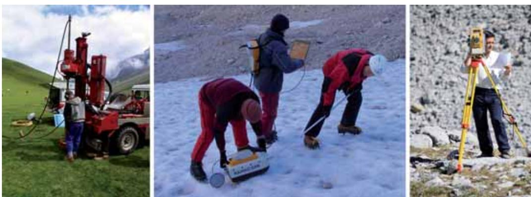
**Figura 1.** Trabajos de campo en los Picos de Europa. Sondeo mecánico en Campo Mayor, sondeo GPR en Jou Negro, y aplicación de IS láser escáner en la Vueltona.
