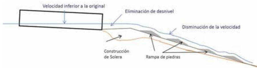
Figura 11.6, Solera y rampa de piedras construidas debajo del drenaje.
