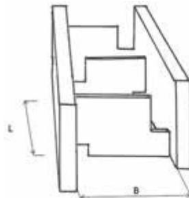
Figura 4.5. Escala de artesas sucesivas de vertedero lateral y orificio de fondo.
