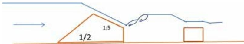
Figura 5.9. Estación de aforos V-flat con dique de descanso
