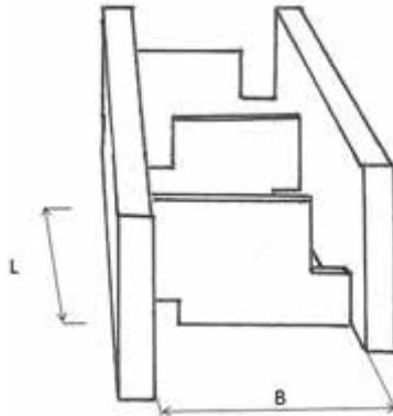
Figura 4.9. Escala de artesas con vertederos lateral semisumergido y orificio de fondo.
