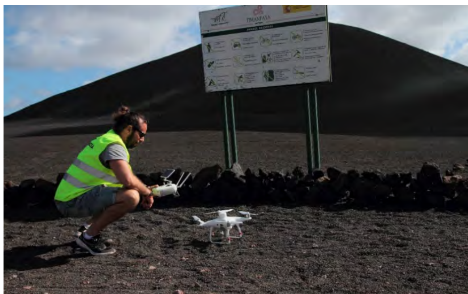
Imagen 16: Vuelo de dron autorizado en el P.N. de Timanfaya para el levantamiento de capas de vegetación. Gustavo Tejera.
