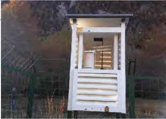
Estación meteorológica en el P.N. de Ordesa y Monte Perdido.
