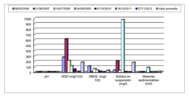
En la gráfica se observan fluctuaciones de los distintos parámetros, con oscilaciones más destacadas en el caso de la DQO, DBO<sub>5</sub> y de los sólidos en suspensión, teniendo un comportamiento regular el pH y, en menor medida, las materias sedimentables.
