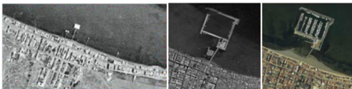
Figura 3.8: Evolución de la playa del puerto de Los Nietos en 1970, 1981 y 2017 donde se aprecia el proceso de formación del tómbolo. Fuente: García-Ayllón, 2018.
