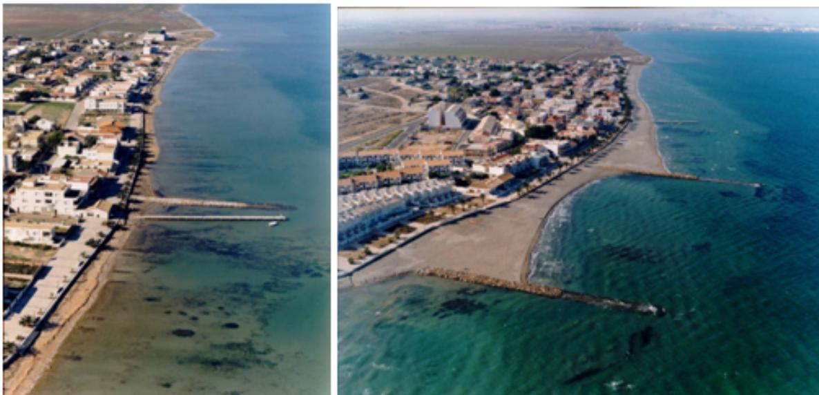
Figura 4.8: Izquierda: imagen de la playa original de Los Urrutias. Derecha: aspecto de la playa tras la construcción de los espigones y el aporte de arena. Fuente: Demarcación de Costas de Murcia.
