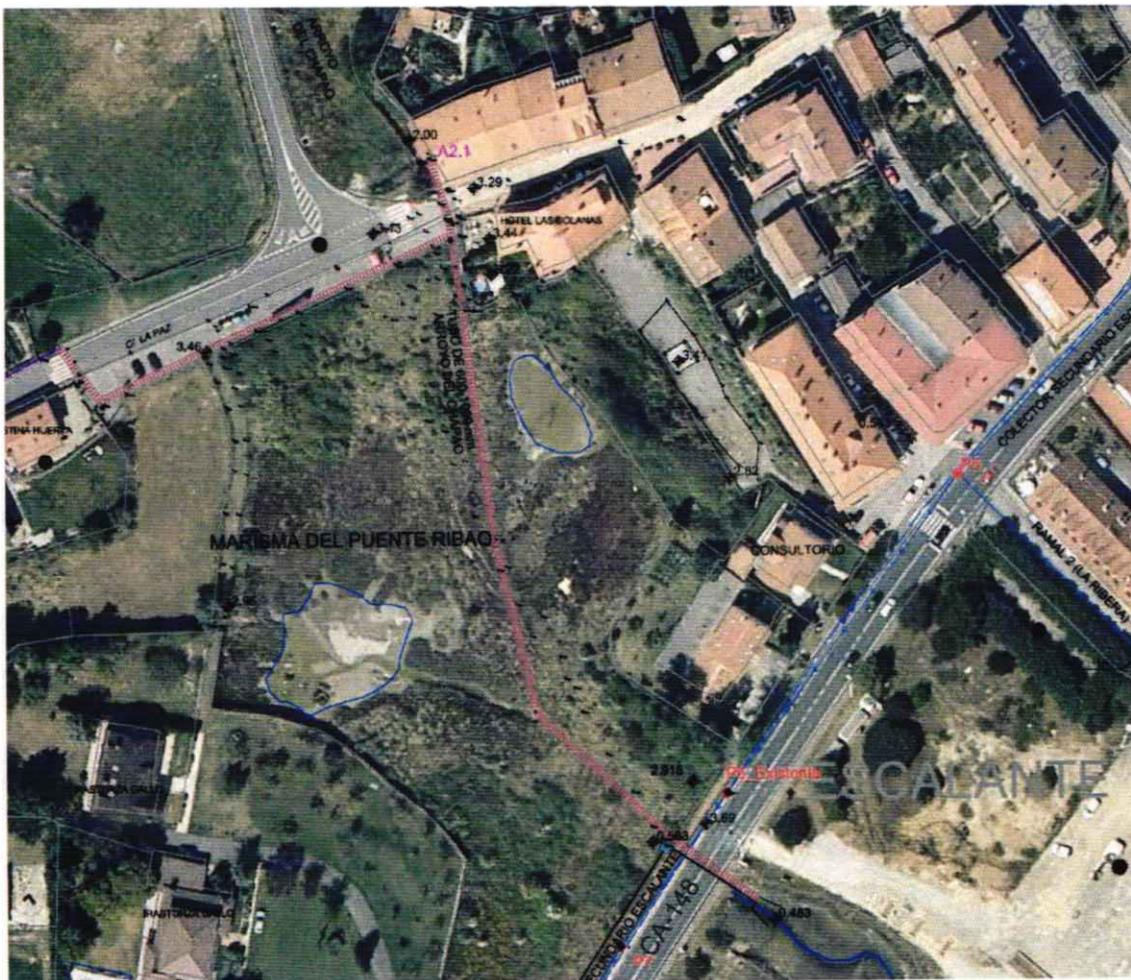
Figura 1. Planta de la Marisma del Puente Ribao. Se señala en trama granate el trazado aproximado del arroyo entubado que discurre por la marisma
